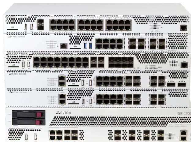
**Семейство маршрутизаторов ESR** — это устройства, представляющие собой универсальную аппаратную платформу и способные выполнять широкий круг задач, связанных с сетевой защитой, шифрованием передаваемых данных, терминированием пользователей и т.д. В линейке представлены модели, ориентированные на применение в сетях различных масштабов — от сетей предприятий различного масштаба до сетей операторов связи и дата-центров.
